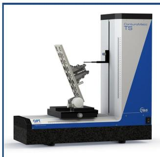
Weitere Aufgaben, die durch die ConturoMatic TS gelöst werden können, sind u.a. die Prüfung von Bohrungen, Abstände von Innen- zu Außenkonturen, Gewinden, Kegelwinkel und Parallelität, Formfehler, Messung von unterbrochenen Flächen, ohne Verlust des Maßbezuges etc.
