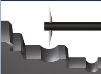
Mehr als die Summe der einzelnen Ideen: Das Konzept hinter allen Systemen der ConturoMatic-Serie, besteht in der Hauptsache aus zwei motorisch gesteuerten Messachsen. Die X-Achse trägt den Prüfling und die Z-Achse übernimmt die Konturenabtastung. Sowohl Messwerterfassung als auch Steuerung basieren konsequent auf modernster Digitaltechnik. Als mechanische Basis dient Granit höchster Qualität.
